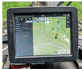
Die Karte von Clear Timber Analytics kann auch auf den Bordrechner des Harvesters übertragen werden. Angezeigt wird es hier mit Timbermatic Maps von John Deere
